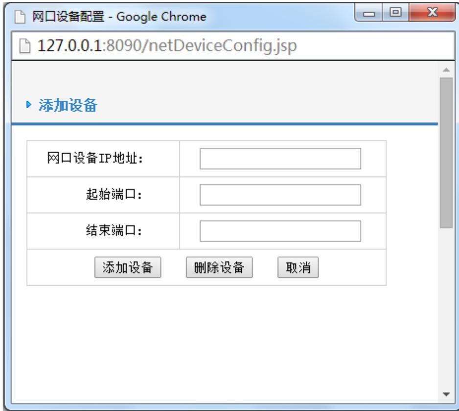
在上图中输入网口设备的 IP 地址, 起始端口和结束端口, 8 口猫池 tcp 模式端口为 961-968, 四口猫池端口为 961-964, 可以通过 telnet ip 地址查看, 点击添加设备, 网口设备配置完成。此时, 可以在金笛短信中间件 web 版界面上点击 [检测设备](#) 按钮, 就可以找到网口设备, 保存后, 启动设备即可。
